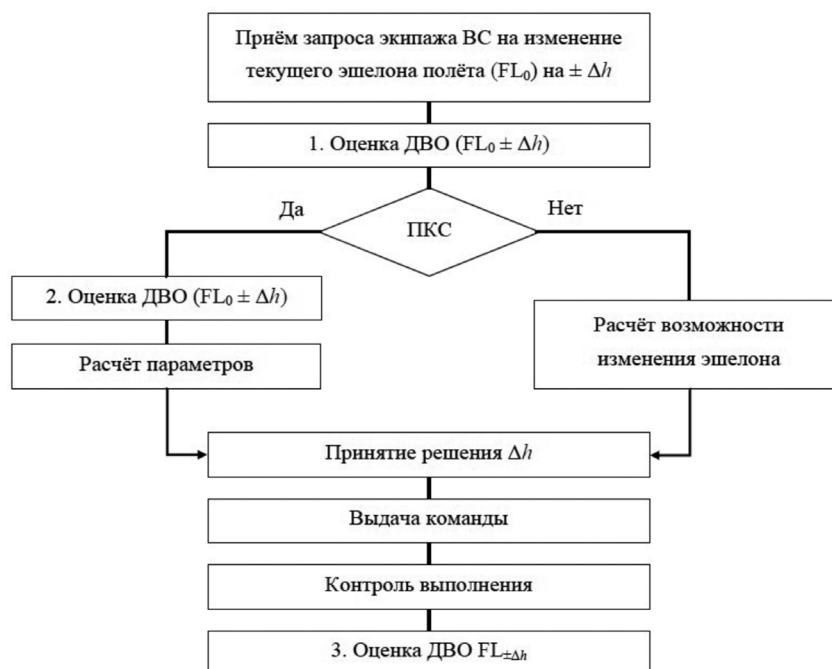
Рис. 1. Алгоритм принятия решения диспетчером УВД при запросе на изменение высоты; ДВО – динамическая воздушная обстановка, ПКС – потенциально конфликтная ситуация, FL_0 – текущий эшелон полёта, \Delta h – изменение высоты, FL_{\pm\Delta h} – новый эшелон полёта
