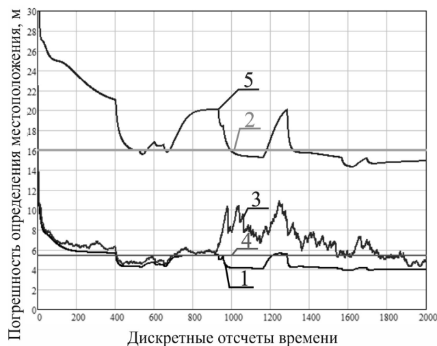
Рис. 4. Погрешности определения МП ВС: расчётные по ковариационным матрицам: 1 – обычный алгоритм, 3 – адаптивный алгоритм; фактические: 2 – обычный алгоритм, 4 – адаптивный алгоритм; 5 – расчётная по ковариационной матрице неадаптивного алгоритма при соответствии модели измерения псевдодальности реальному процессу
