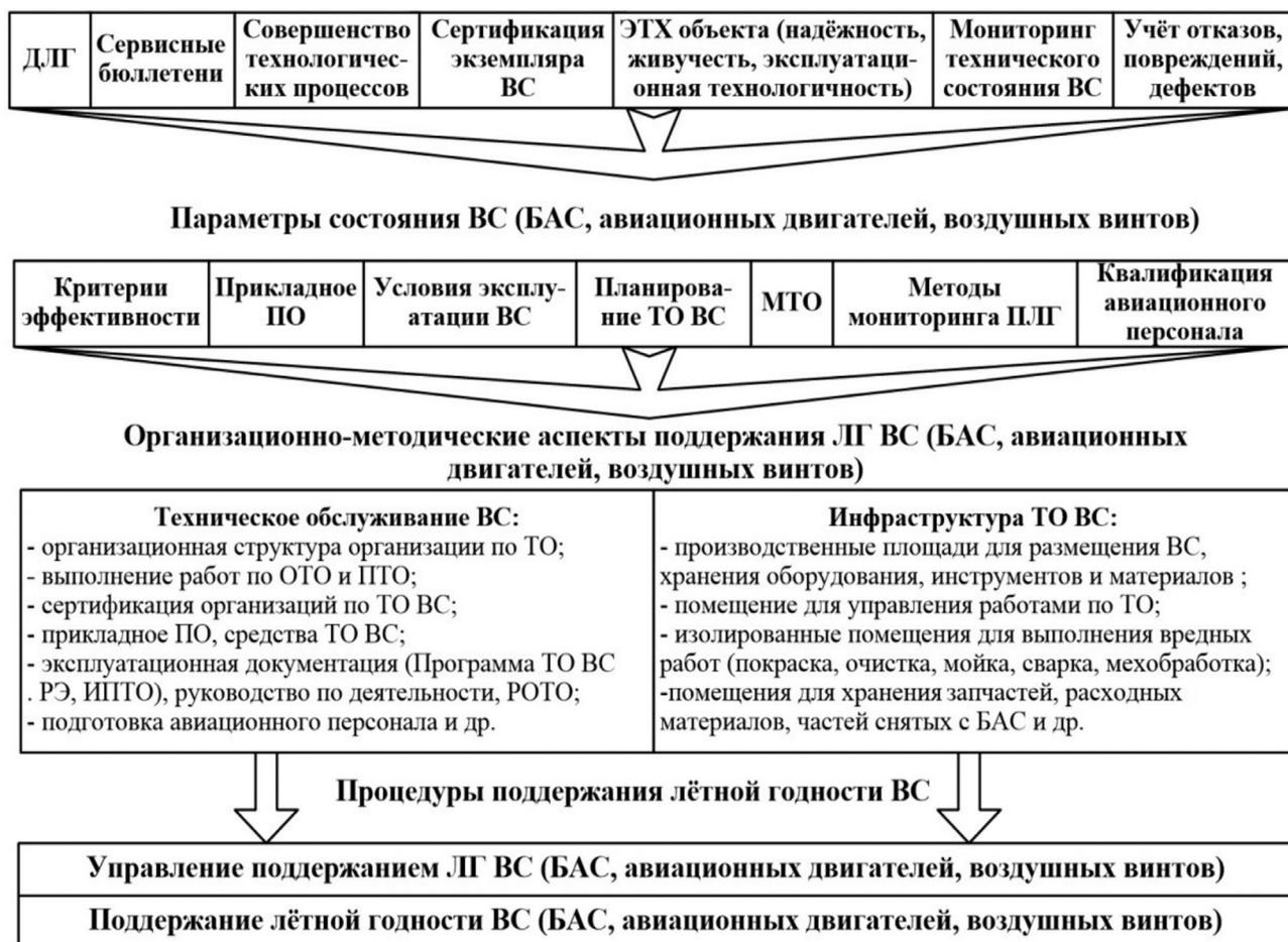
**Рис. 1.** Факторы, влияющие на ПЛГ ВС (БАС, авиационные двигатели, воздушные винты):
