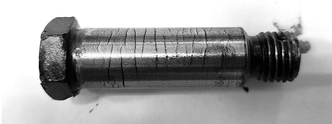
**Рис. 5.** Трещины болта черт. 24-4201-273 механизма управления поворотом передней опоры шасси
