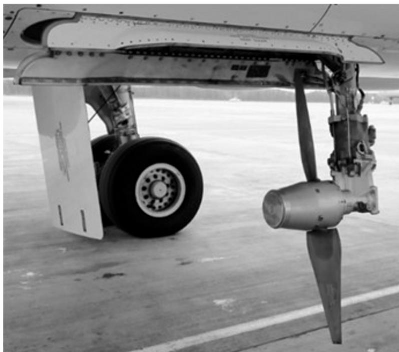
Рис. 2. ТНУ на Airbus A320
