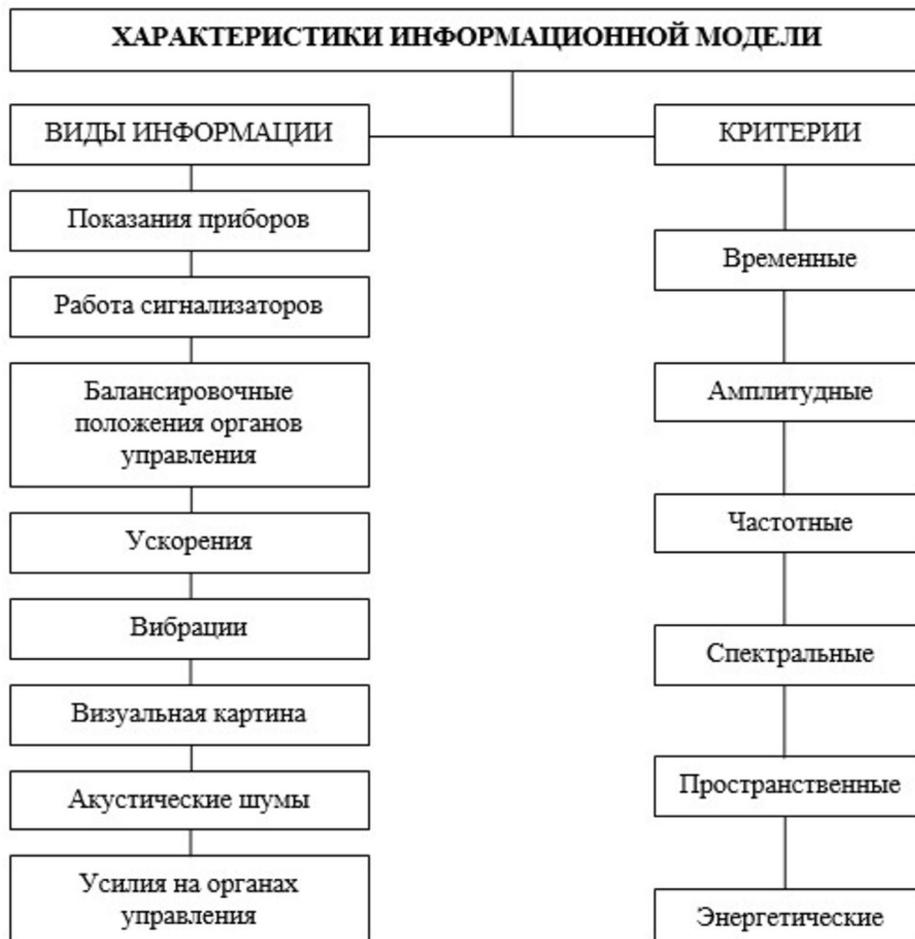
Рис. 1. Структура информационной модели комплексного тренажёра
