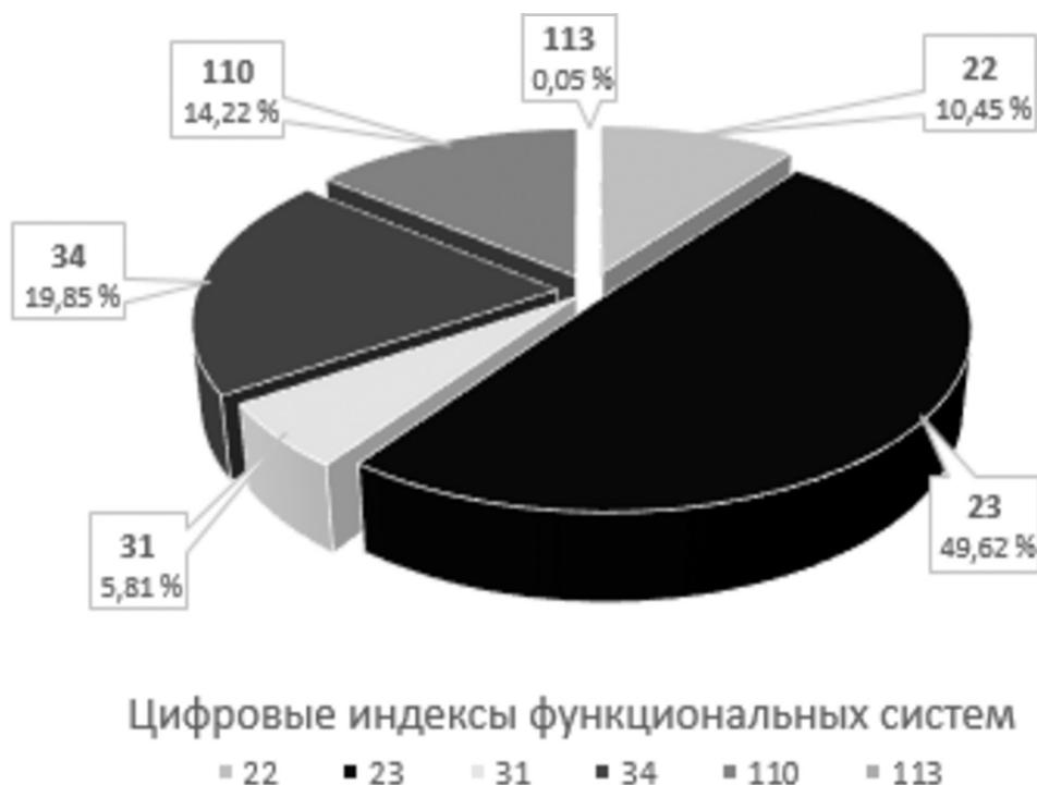
Диаграмма распределения отказов и неисправностей ПНиРЭО по функциональным системам на парке Ми-8Т в период с 2020 по 2022 г.
