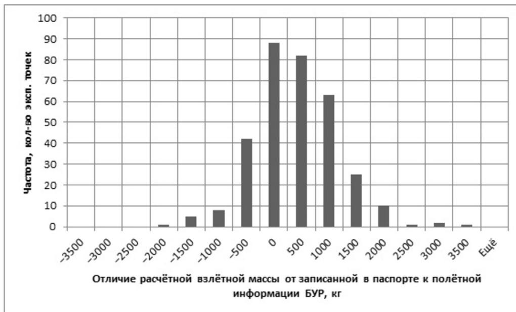
Рис. 1. Распределение отклонений расчётного значения взлётной массы от паспортной (массив экспериментальных точек при оценке свободной тяги на висении)
