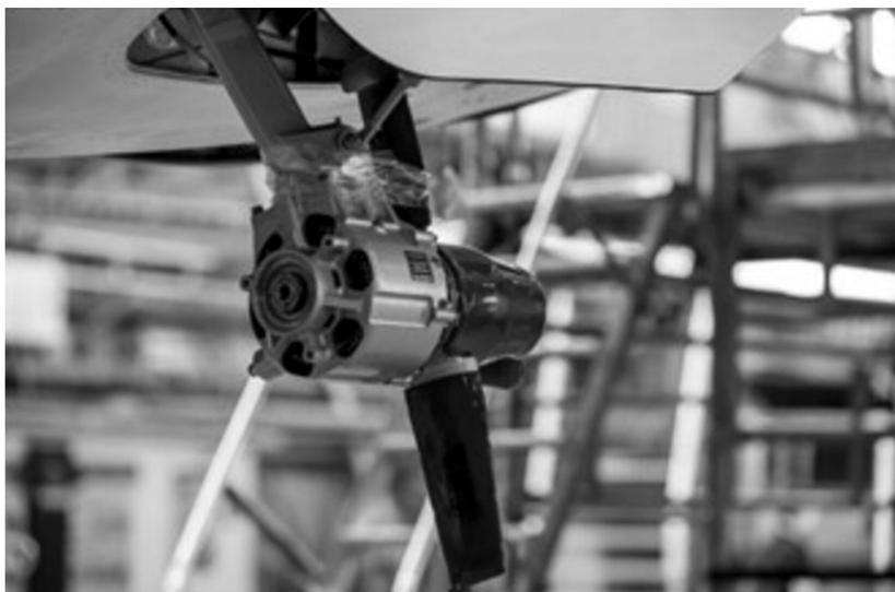
Рис. 1. Модуль ТВАГ самолёта SSJ-95В
