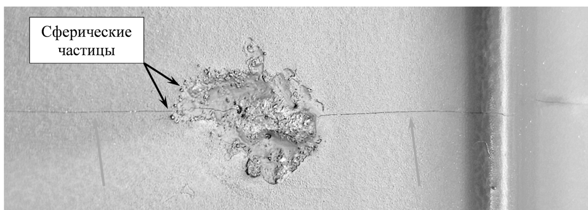
Рис. 1. Вид повреждения на внутренней поверхности лонжерона лопасти, от которого развивалась трещина (указана стрелками)
