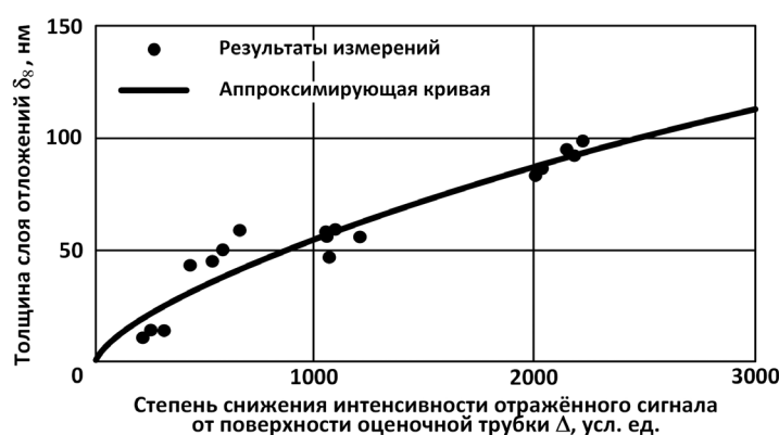
Рис. 5. Экспериментальные данные и аппроксимирующая зависимость \Delta и \delta_8 для гидроочищенного компонента топлива ТС-1. Коэффициент корреляции r[(\Delta^a + \Delta), \delta] = 0,947 при его критическом значении r_{кр} = 0,468 (для доверительной вероятности 0,95 и числа степеней свободы, равного 16)
