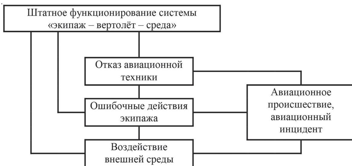
Рис. 1. Структура возможных условий возникновения авиационных происшествий, авиационных инцидентов и предпосылок к ним
