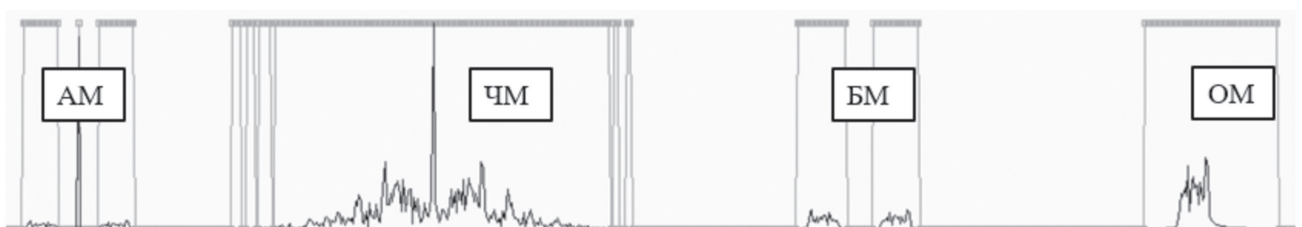
Рис. 4.б. Значение интервала между соседними участками спектра недостаточно – АМ сигнал разбит на боковые лепестки и отдельную несущую, ЧМ сигнал разбит на множество составляющих
