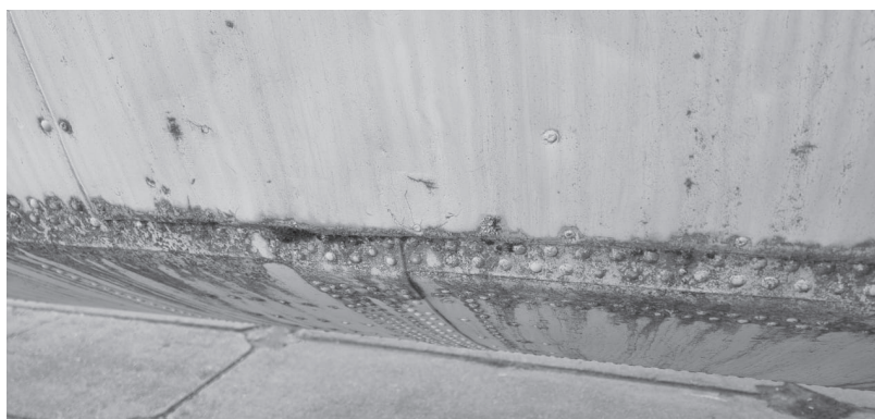
Рис. 2. Загрязнение обшивки нижней части планера самолёта Ан-26
