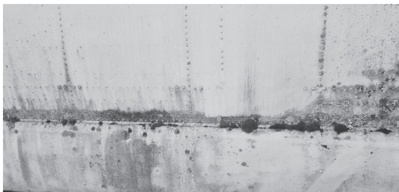
Рис. 1. Загрязнение стыка обшивок фюзеляжа самолёта Ан-26
