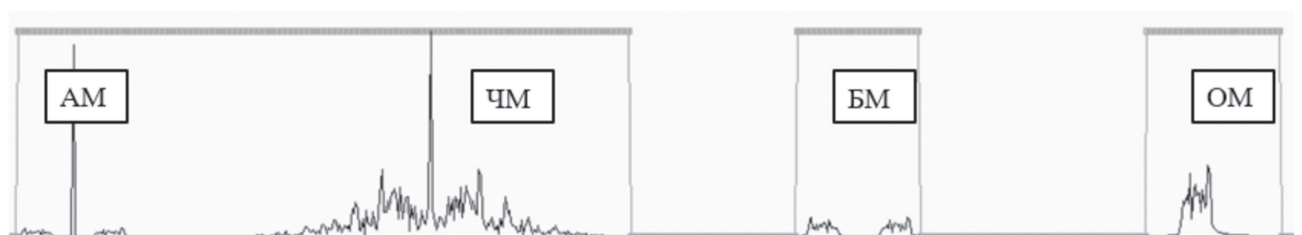
Рис. 4.б. Значение интервала между соседними участками спектра велико – АМ и ЧМ сигнал «слиплись», БМ сигнал воспринимается единой частью
