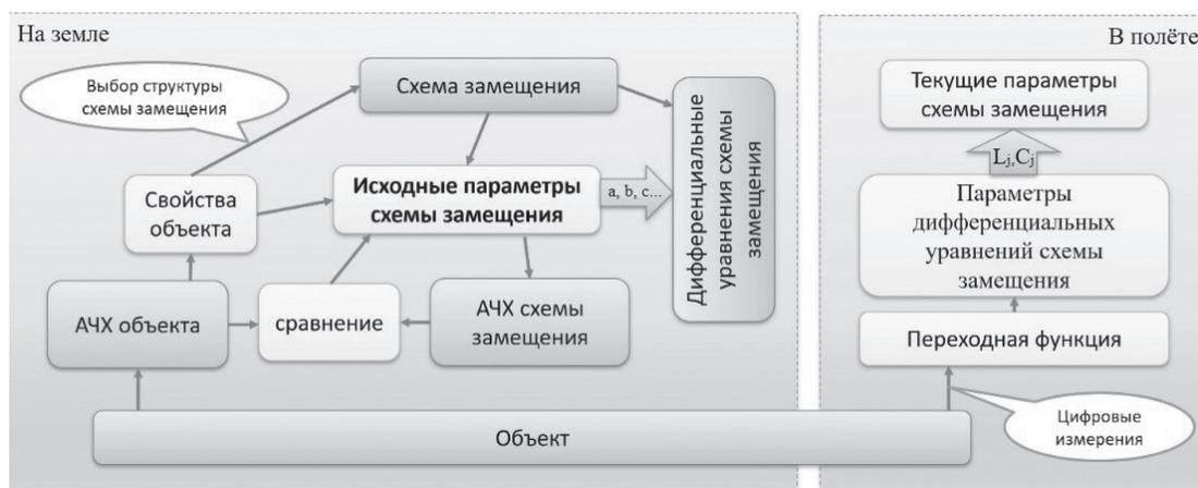
Рис. 2. Методика определения параметров эквивалентных электрических схем замещения
