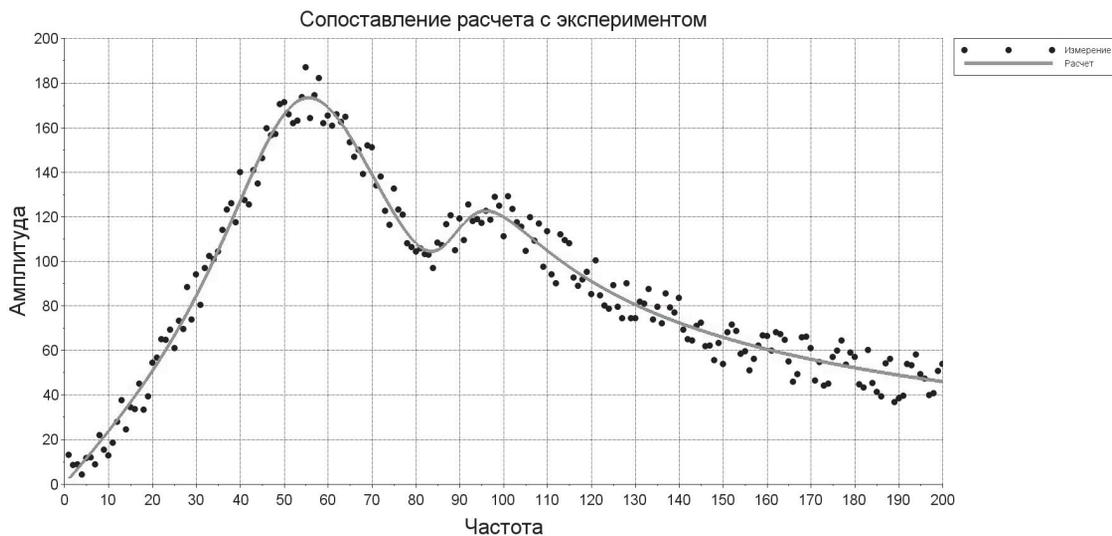
Рис. 6. График аппроксимации с погрешностью 7,5 %
