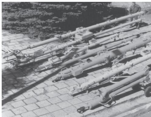
**Рис. 2.** Разновидности унифицированных буксировочных водил
