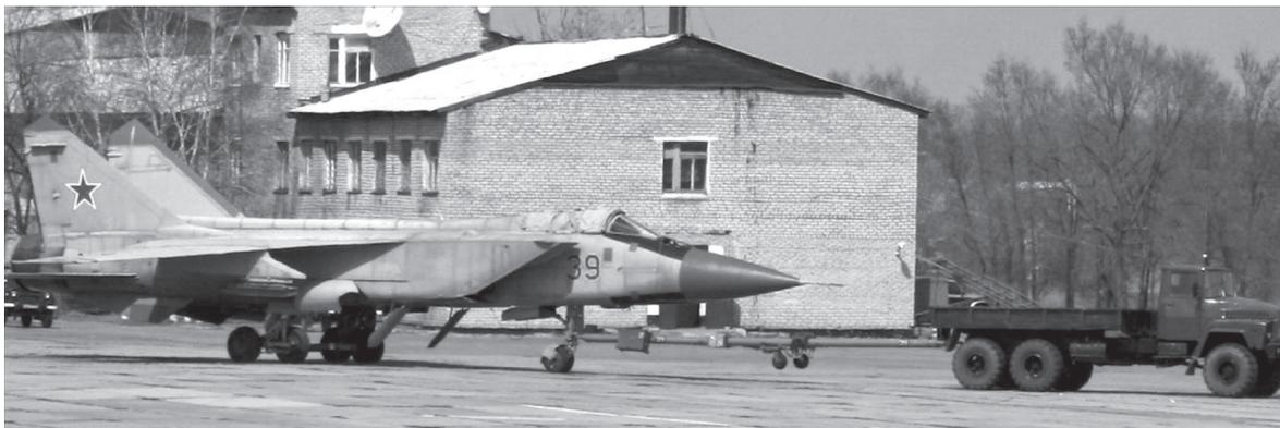
Рис. 1. Буксировка ВС колёсным тягачом с использованием водила
