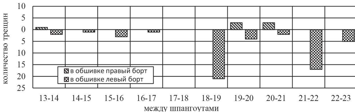
**Рис. 5.** Гистограмма распределения в продольном направлении ЦЧФ суммарного количества трещин в обшивке по правому и левому бортам в пределах гаргрота
