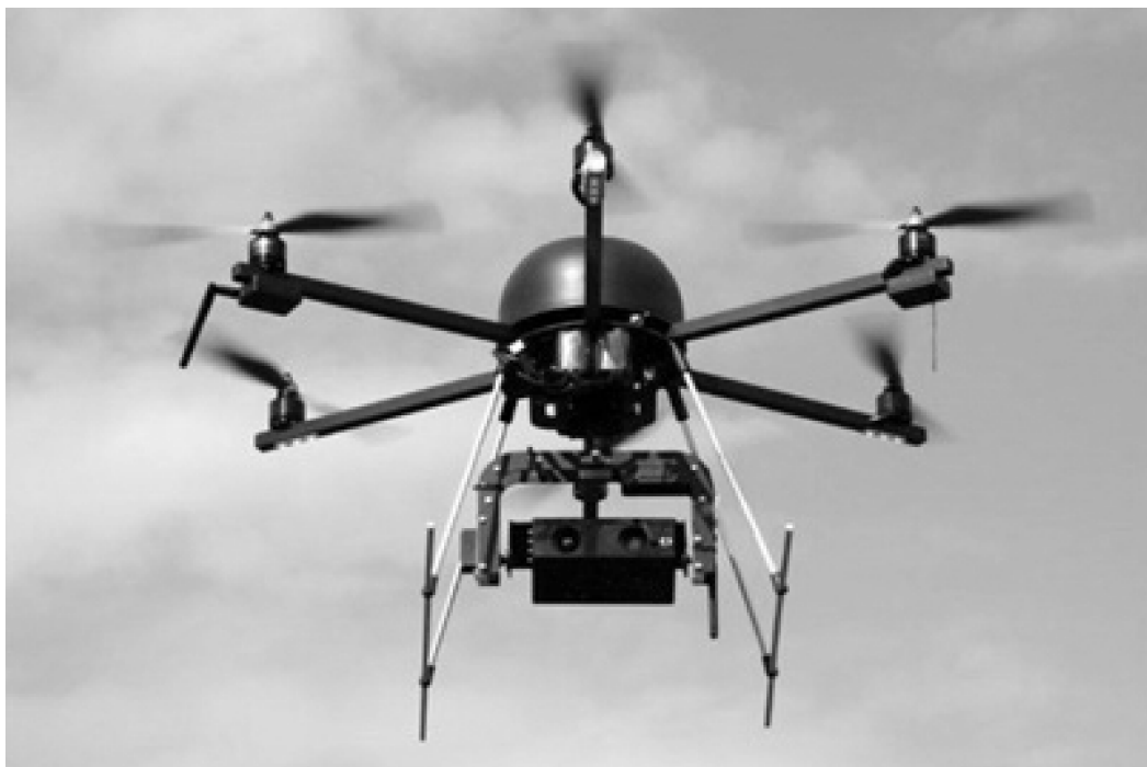
Рис. 1. Примерный технический облик БКХРГ в компоновке: БПЛА МРТ с видеокамерой, газоанализатором на основе пьезосенсоров с блоком питания, блоком управления и аналитическим модулем
