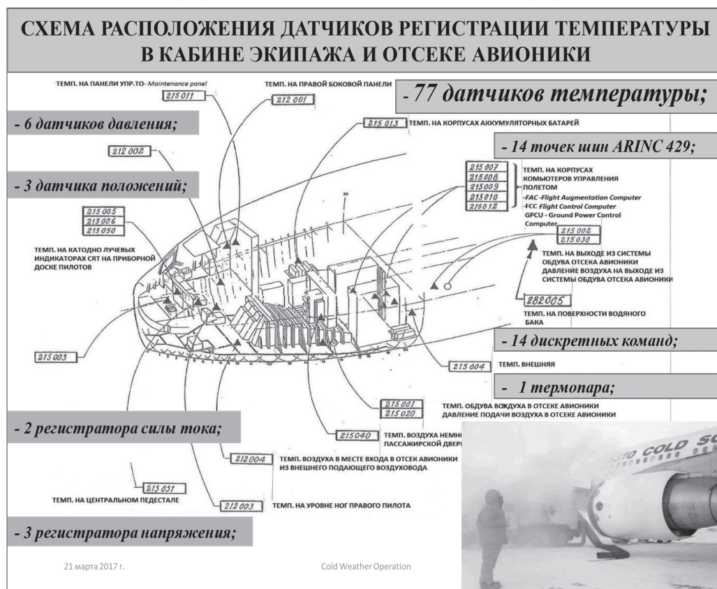
Рис. 5. Блок-схема расположения датчиков регистрации параметров и температуры полей в кабине экипажа и отсеке авионики
