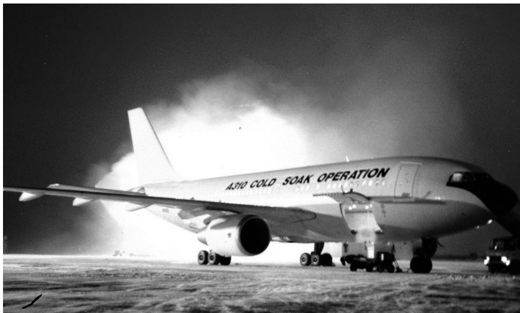
Рис. 4. Специально подготовленное для натурных испытаний по программе метода глубокой заморозки (Cold Soak Test) ВС Airbus A310-325 сер. № MSN687 на открытой площадке в аэропорту Якутск, февраль 1996 года
