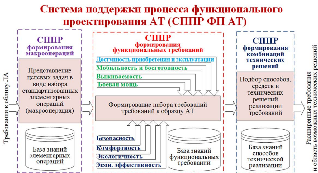
Рис. 1. Состав и структура системы поддержки процесса функционального проектирования АТ
