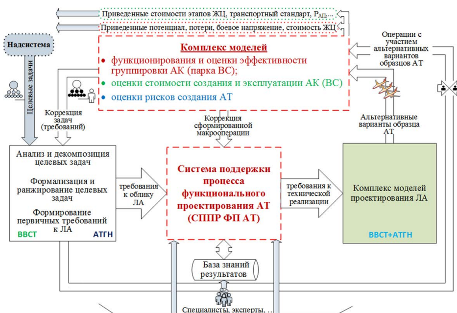
Рис. 2. Место и роль СППР ФП АТ в общем комплексе исследований, связанных с созданием новой техники
