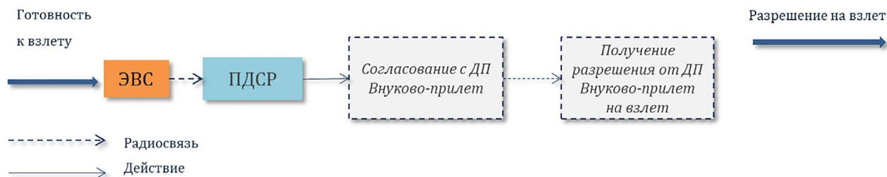
Рис. 7. Алгоритм действий ПДСР при вылете ВС
