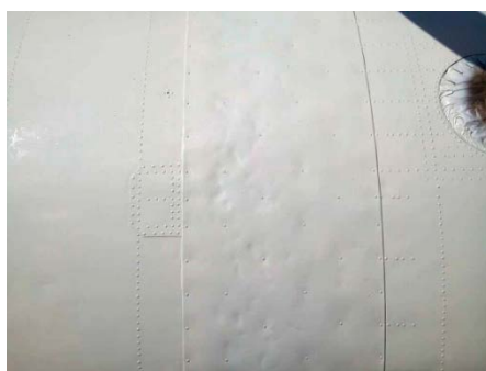
Рис. 3. Повреждения (вмятины) на накладном защитном листе боковой поверхности средней части фюзеляжа самолета Ан-24
