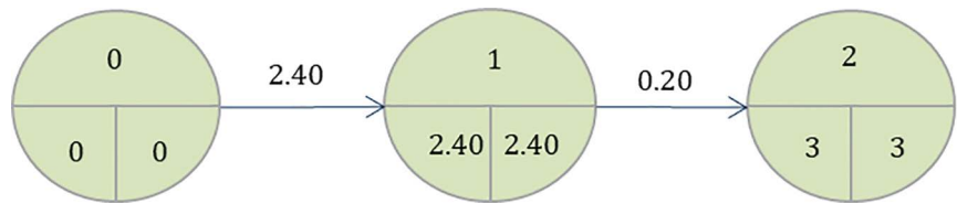
Рис. 8. Сетевой технологический график взаимодействия ПДСР и ДП Внуково-прилет при вылете F7X.
