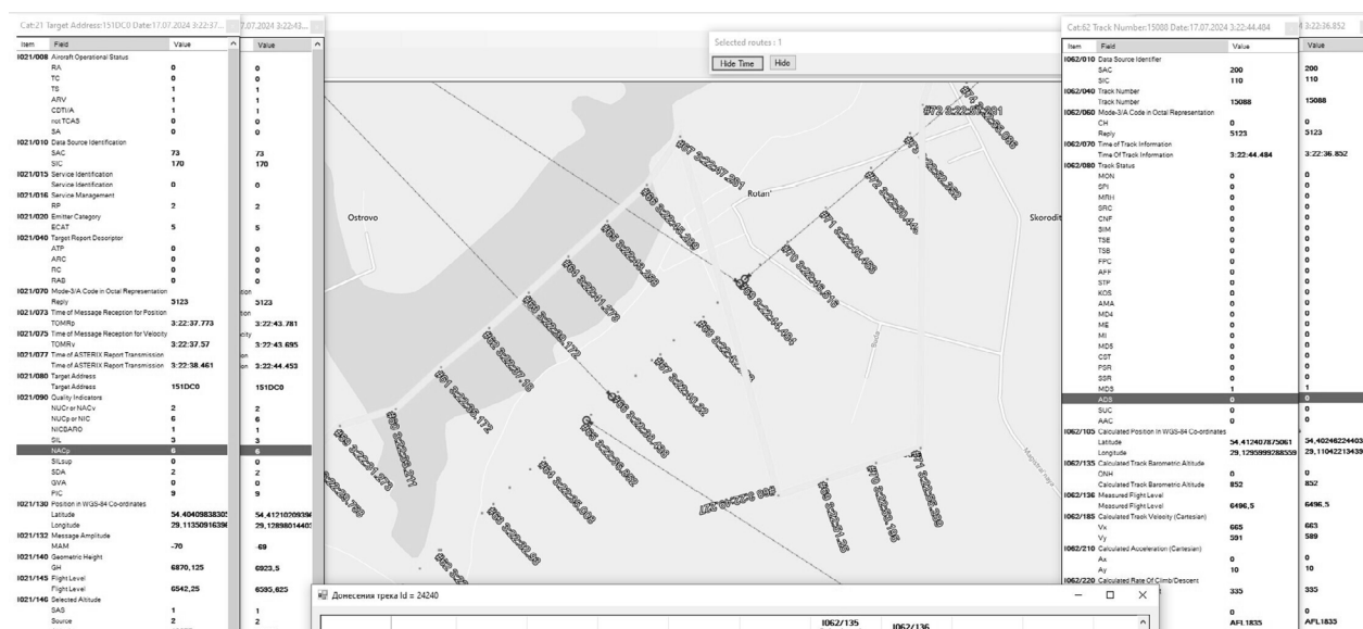
Рис. 2. Использование данных АЗН-В в качестве опорных при оценке точности СН ОВД
