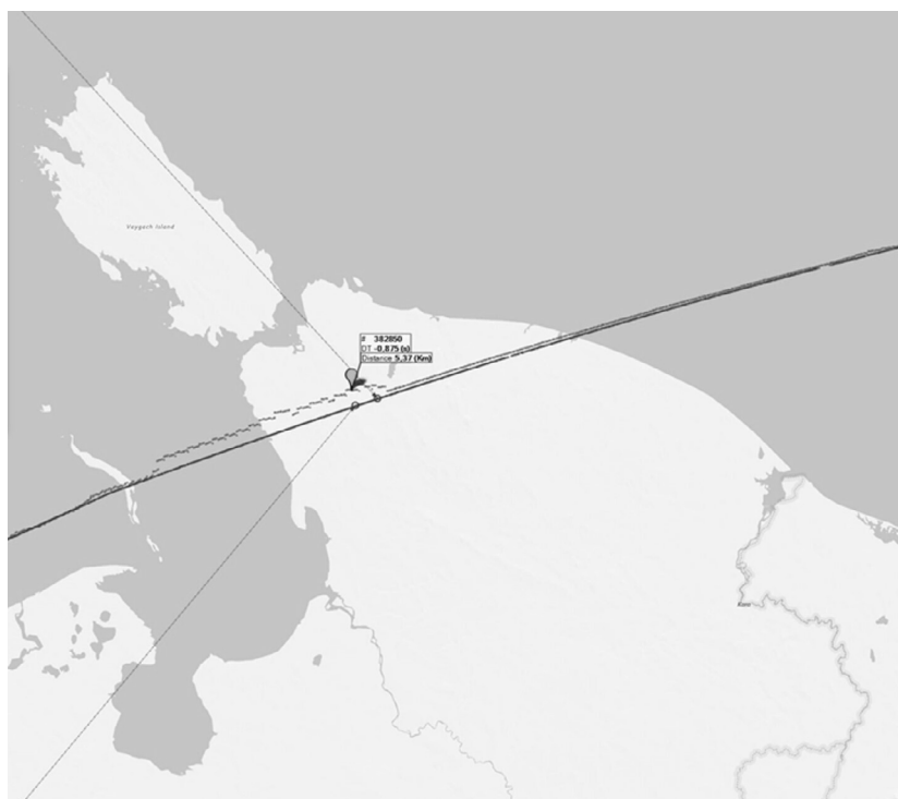
Рис. 3. Использование данных АЗН-В (сплошная ровная линия точек) в качестве опорных при оценке точности СН ОВД в конфигурации только РЛИ (ломаная линия выше линии точек АЗН-В)
