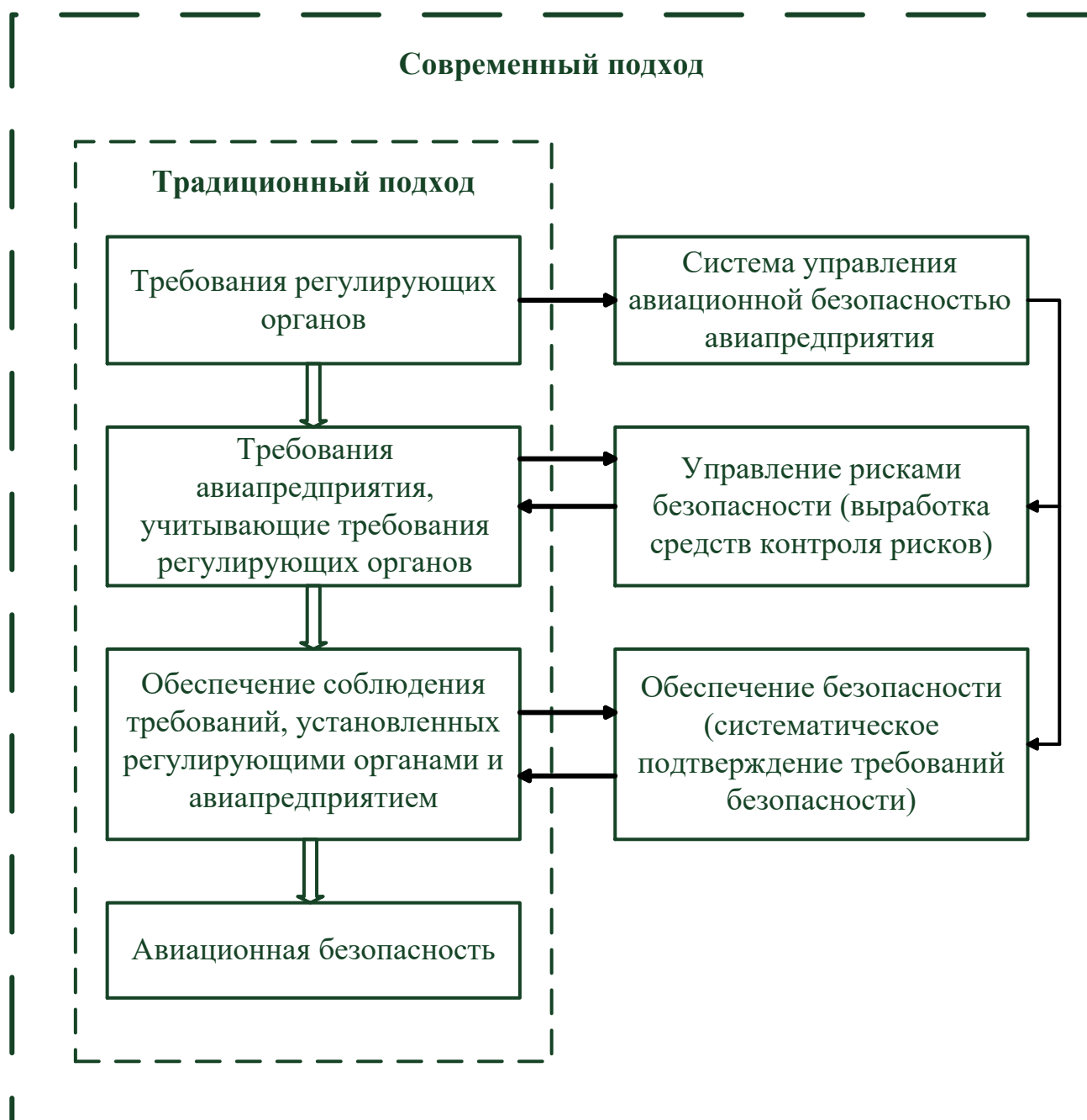
Рисунок 2.1 – Современный подход к системе управления АВ
