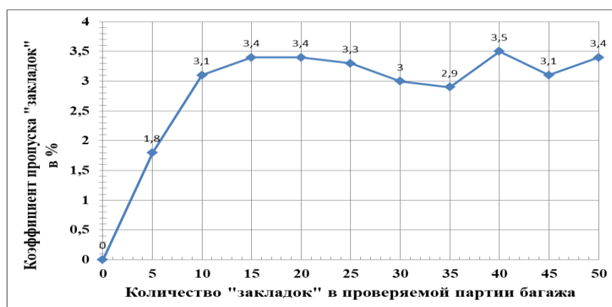
Рисунок 7 – Зависимость коэффициента пропуска «закладок» от количества «закладок» в проверяемой партии багажа
